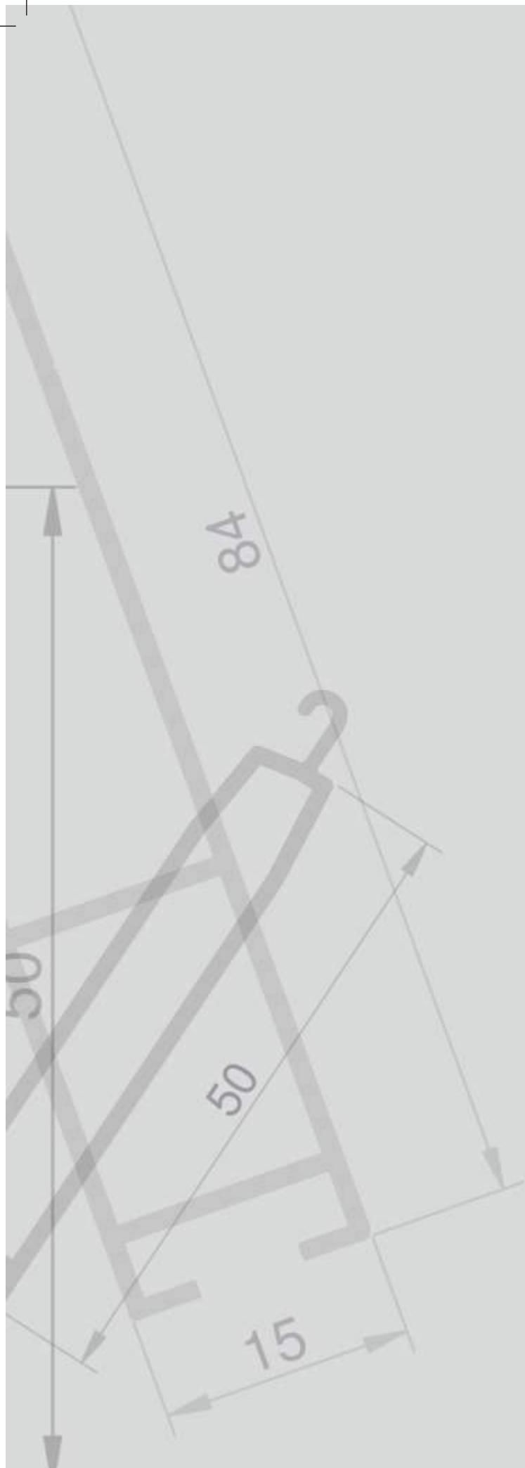
**50 mm Alt Parça (39 mm Lameller İle Kullanılır)**
